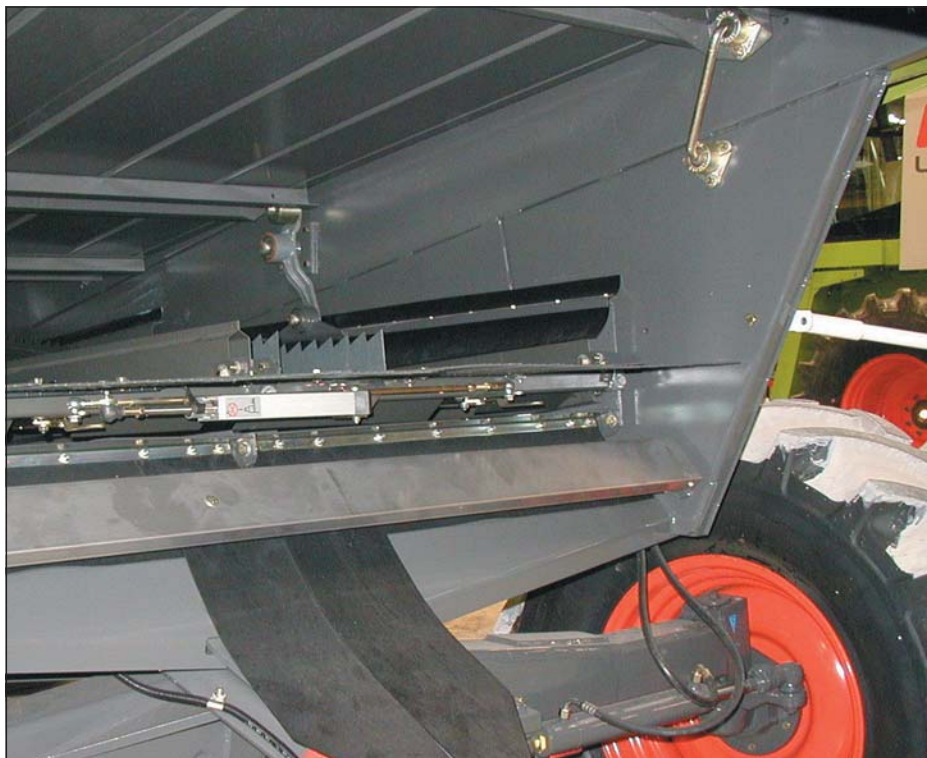
Mährescher-Siebverstellung durch Elektrozyylinder Baureihe 015. Einsatz unter extremen Bedingungen (Hitze, Staub und Erschütterungen). Screen adjustment in a combine harvester using electric cylinders of our 015 series. Use in extreme conditions (heat, dust and vibrations).
