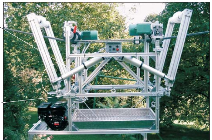
Foto K+G Maschinen- u. Elektrotechnik GmbH: Seilfahrwagen für den Hochspannungsleitungsbau. Das Heben und Senken der Hubarme erfolgt über RK-Elektrozyylinder LZ 60 S. Photo K+G Maschinen- u. Elektrotechnik GmbH: Power grid cable construction cradle. The lifting arms are lifted and lowered using RK LZ 60 S electric cylinders.
