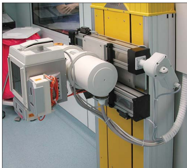
Röntengerät: Seitenverstellung über EHL mit RK DuoLine S, Höhenverstellung über RK Easylift.
