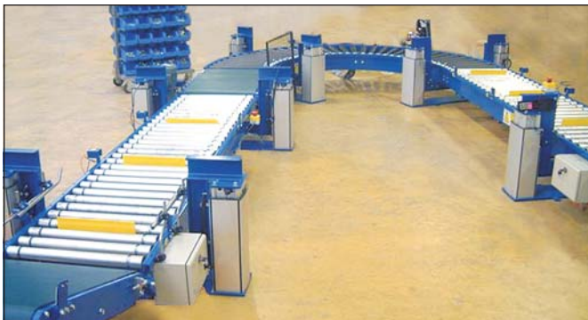
Förderstrecken-Höhenverstellung mit RKPowerlift . Conveyor height adjustment with RKPowerlift .
