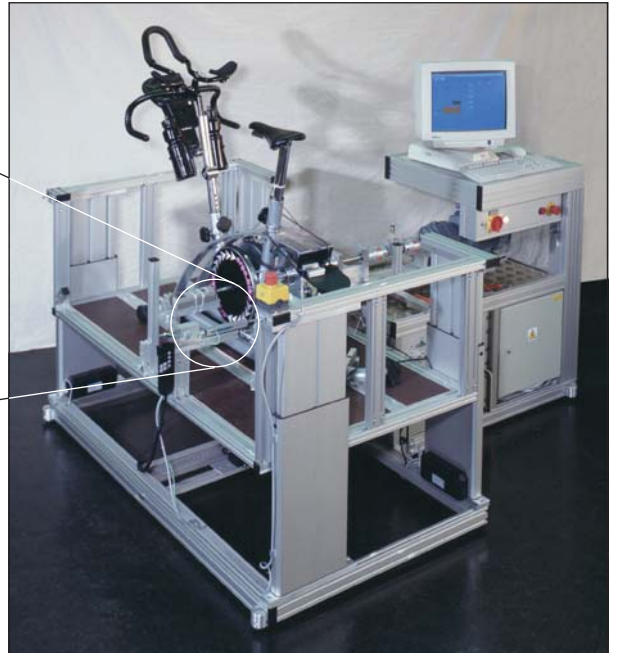
Prüfstand: Höhenverstellung über Multilift-Hubsäulen, Positionierung von Messeinrichtungen mittels Elektrozyylinder Testing stand: height adjustment by means of Multilift lifting columns, positioning of measuring systems by means of electric cylinders
