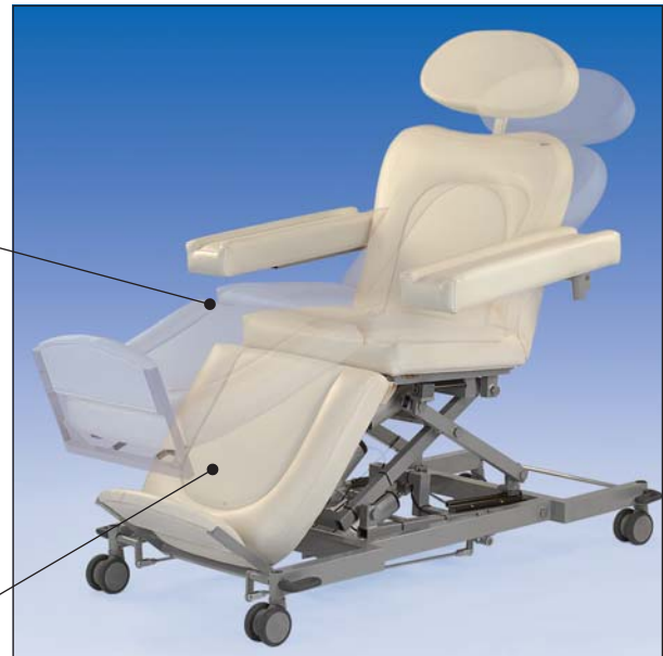
Dialyseliege: Verstellung der Positionen über vier Elektrozyylinder LZ 60 P. Dialysis couch: positioning by means of four electric cylinders LZ 60 P.
